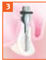
3 OPTIONNEL POUR OS DENSE T3.3 Taraud pour os 3,3mm
